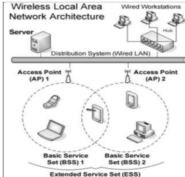
**Fig. 3-9 Componentes de una WLAN**
