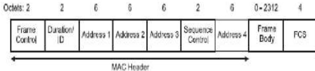
**Fig. 3-11 Estructura de una trama**
