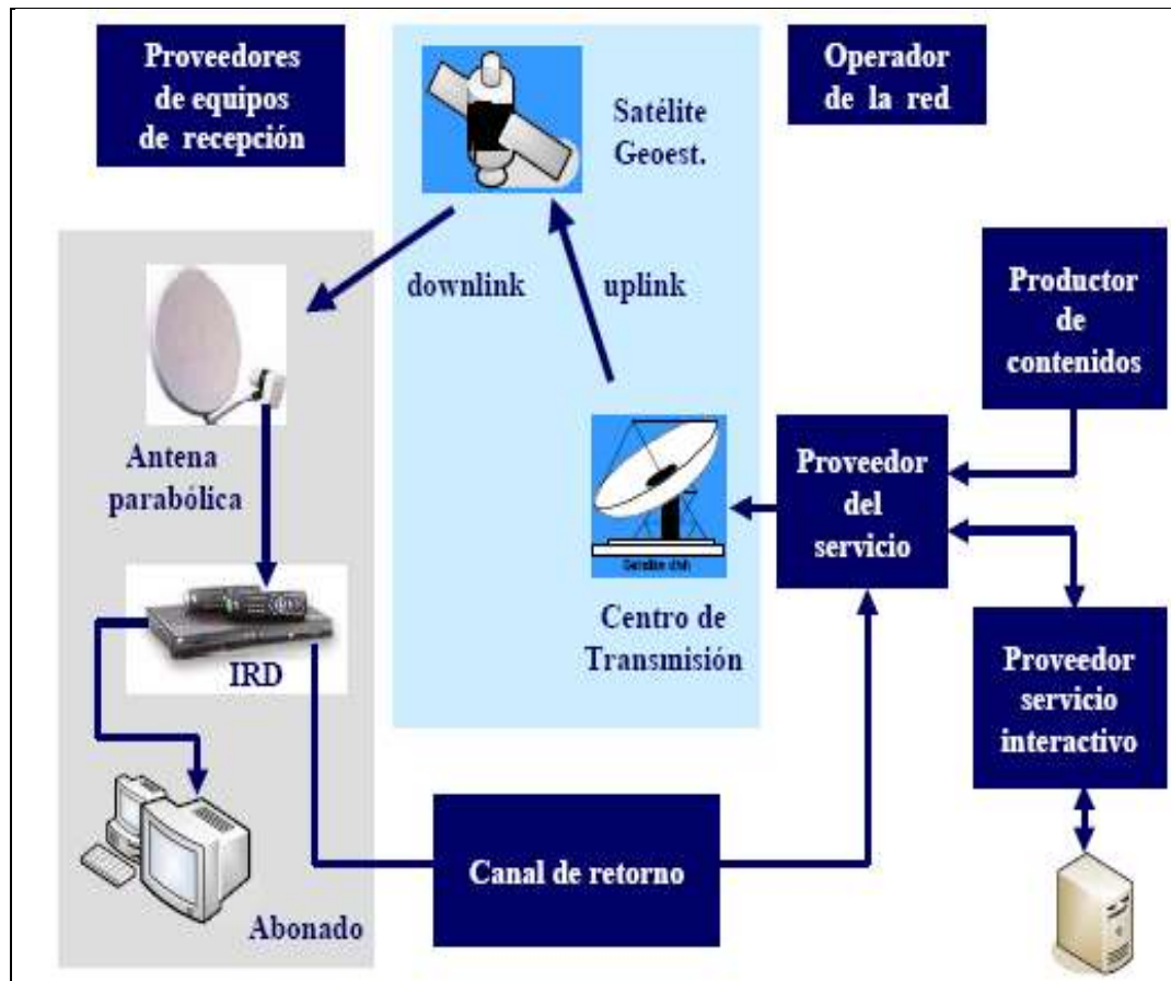
Fig.1-9 Estructura de un sistema TDH
