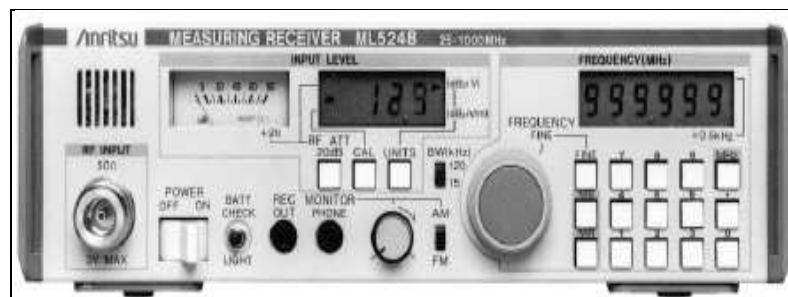
Fig. 4-13 Medidor Intensidad de Campo
