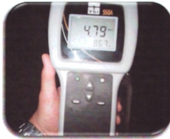
Figura 21. Medición de la concentración de oxígeno
