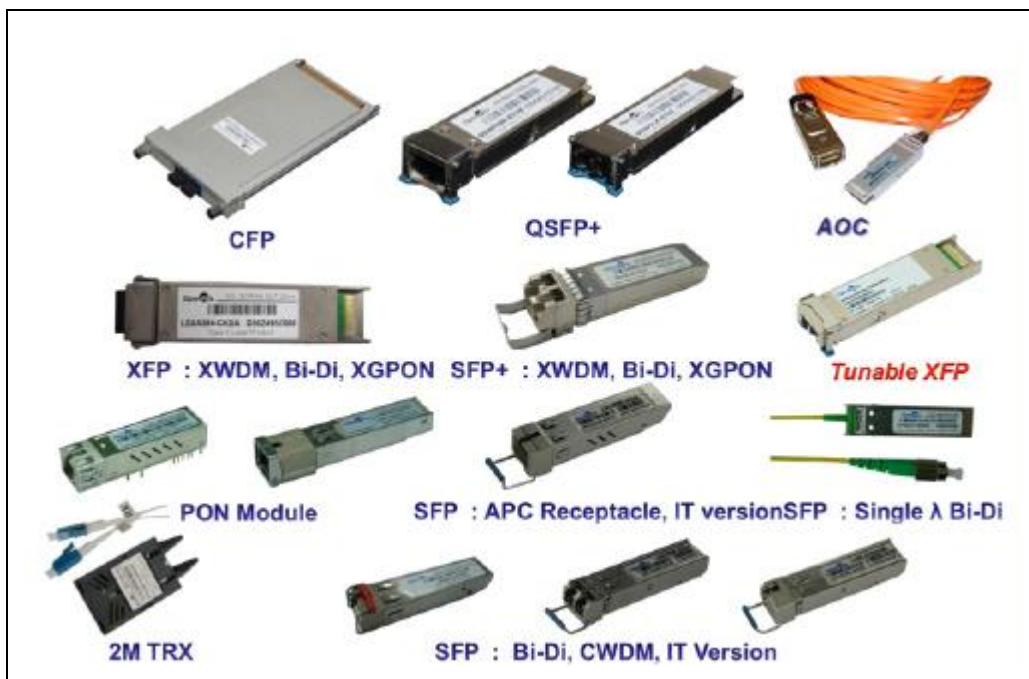
Figura 2.29 Módulos de transmisión ópticos.
