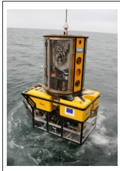
Figura 3.26 Vehículo operacional remoto sumergiéndose a fin de realizar labores exploratorias en el lecho marino.
