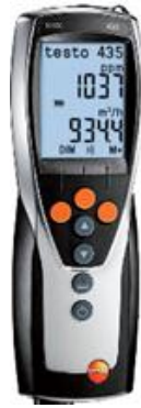
Figura 3.17. Medidor ambiental TESTO 435.
