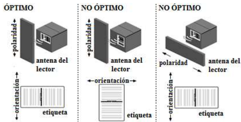
Figura. 2.16. Orientación adecuada de la antena de la etiqueta pasiva de RFID
