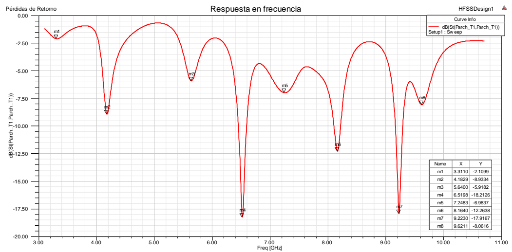
Figura 3.9. Respuesta en frecuencia de la antena transmisora con 2 resonadores en el plano tierra. Elaborada por el Autor
