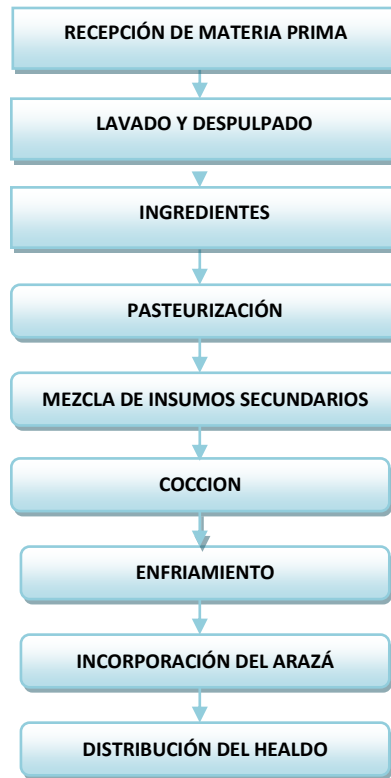
Diagrama 6.4.2: Flujo Productivo Helado Elaborado por las Autoras
