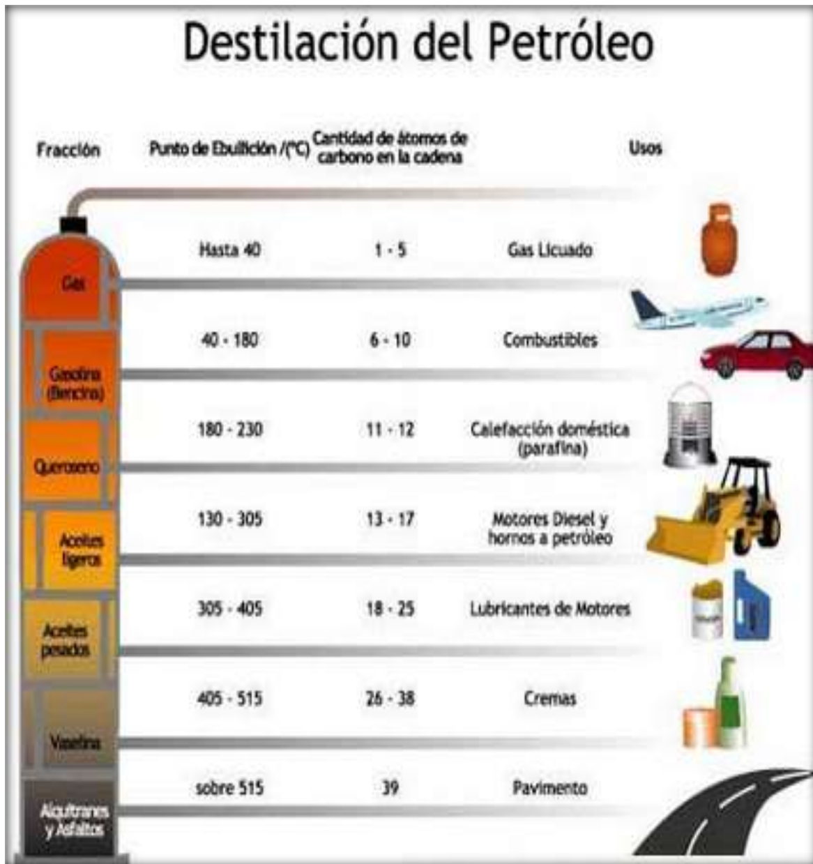
Figura C: Aplicación de la destilación del Petróleo por industria
