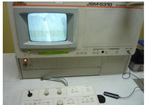
Figura 19.- A. Muestras recubiertas en oro en proceso para el scanning- B. MEB visualización del interior del conducto
