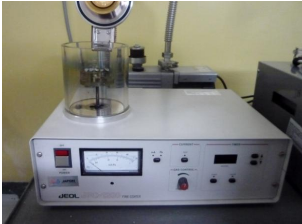
Figura 18.- A. Equipo Recubridor de Oro - B. Recubrimiento de oro “Destelleo”
