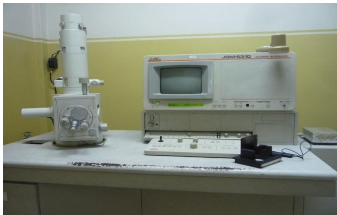
Figura 16.- Microscopio Electrónico de Barrido JSM-5310 (MEB).
