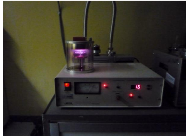
Figura 18.- A. Equipo Recubridor de Oro - B. Recubrimiento de oro “Destelleo”
