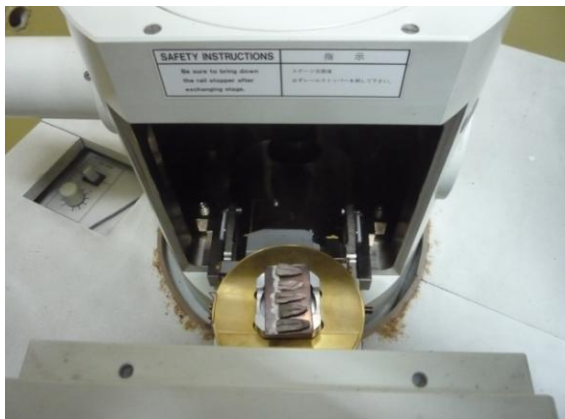
Figura 19.- A. Muestras recubiertas en oro en proceso para el scanning- B. MEB visualización del interior del conducto
