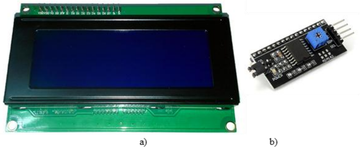
Figura 3.26.a) LCD 20x4 Hitachi HD44780, b) controlador I2C.
