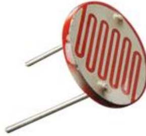
Figura 2.7. Resistencia dependiente de luz (LDR). Fuente: (PROMETEC, 2016)
