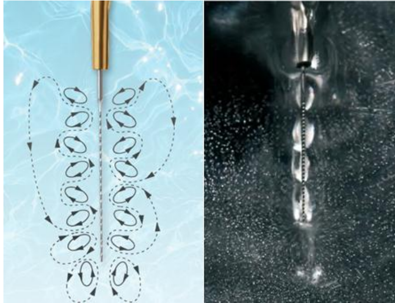
Figura 2.- Mecanismo de lavado de lima ultrasónica (izq.) Transmisión acústica alrededor de la lima en agua libre (der).
