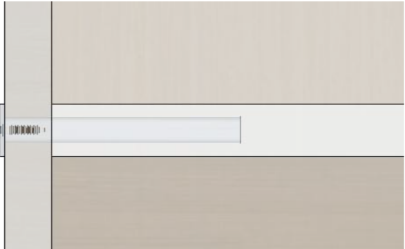
2. Detalle de fijación de repisas
