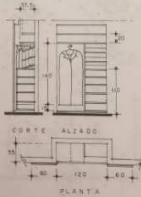
9.7. Closet con anaqueles, cajones y espacio para colgar trajes con dos puertas abatibles.
