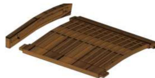
Ensamble central a caja y espiga aboquillado.
