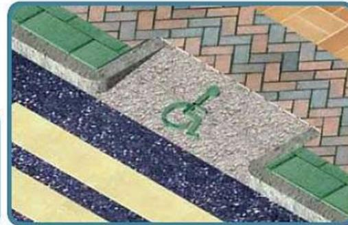
La longitud de cada tramo de rampa, medida en proyección horizontal debe ser máximo de 10 m.
