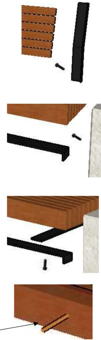
Respaldar: fijación de acero galvanizado a tablas de madera con pernos 4.5" 8mm. Color negro grafito.
