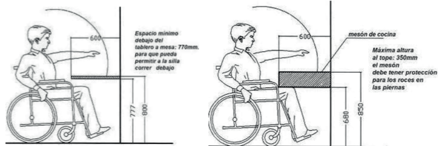
FIGURA 36. ACCESIBILIDAD Superficies de trabajo. Tableros- mesones de cocina
