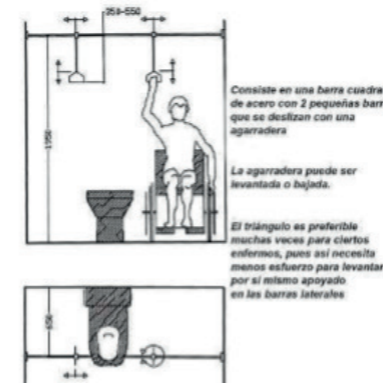
FIGURA 50. BAÑOS (Sin ayuda) BAÑOS Medidas mínimas Triángulos de asidero
