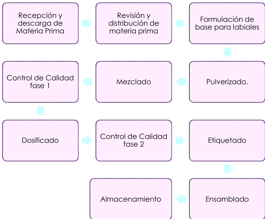
Ilustración 33: Flujograma de proceso productivo
