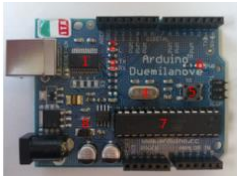
Figura 2. 16: Componentes principales de la tarjeta Arduino Duemilanove. Fuente:(Varesano, 2011)
