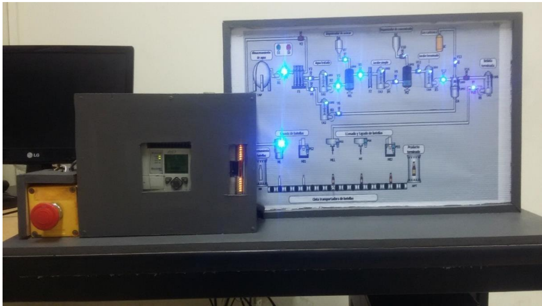
Figura E.1.- Maqueta simplificada del sistema de producción y envasado de gaseosas.
