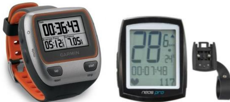
Figura 2. 1 Relojes con tecnología ANT para medir parámetros en entrenamientos Fuente: (Linio, 2016)
