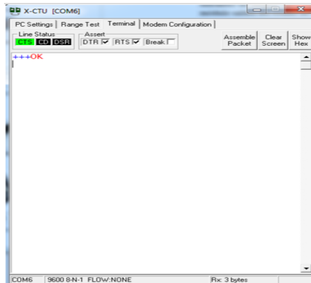
Figura 2. 16 Entrada en el modo de comandos mediante el software X-CTU Fuente: (Iraceburu González & Goicoechea Fernández, 2014)
