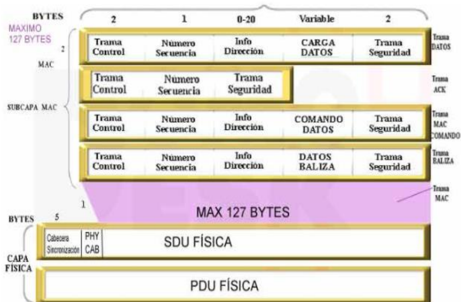
Figura 2. 6. Tramas Zigbee en Capa Física y Capa MAC
