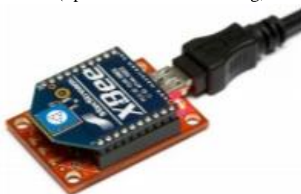
Figura 2. 20 Conexión del módulo Xbee al Explorer USB Fuente: (SparkFun Start Something, 2003)
