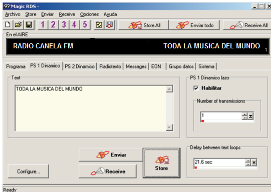
Figura 3. 8: Configuración caracteres en el software magic RDS Fuente: Autor
