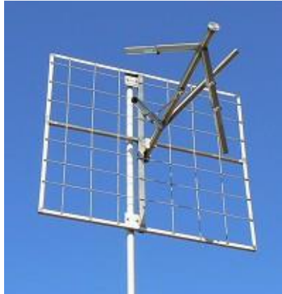
Figura 2. 16: Antena Dipolo en V Fuente: (Ramos Francisco, 2017)
