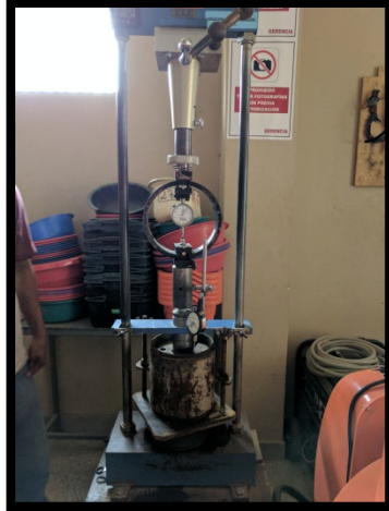
Figura 8. Ensayo de Penetración
