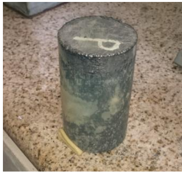
Figura 21. Colocación de la membrana a la briqueta
