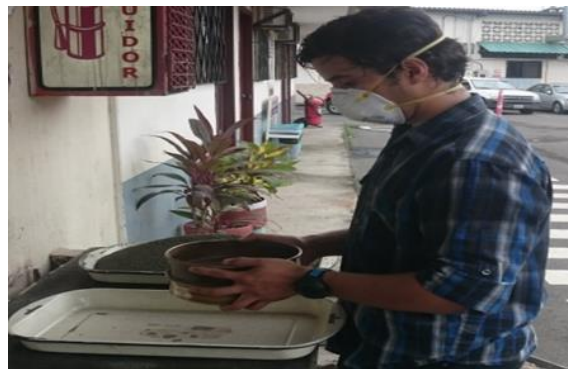
Figura 12. Proceso de tamización del agregado
