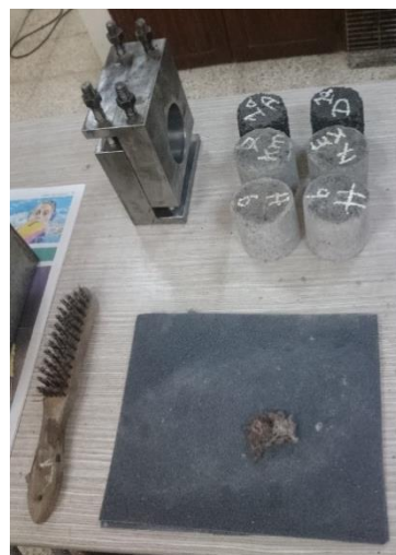
Figura 26. Proceso de lijado de las briquetas
