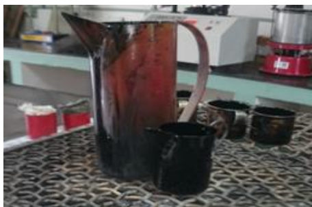
Figura 15. Asfalto calentado en estufa
