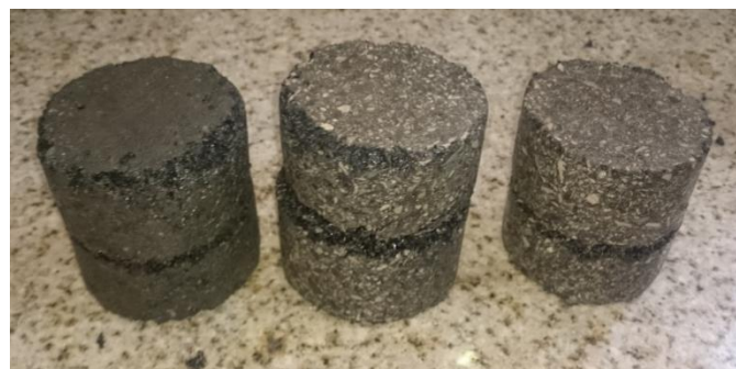
Foto 9: Muestras cilíndricas ya ensayadas en ensayo de corte directo
