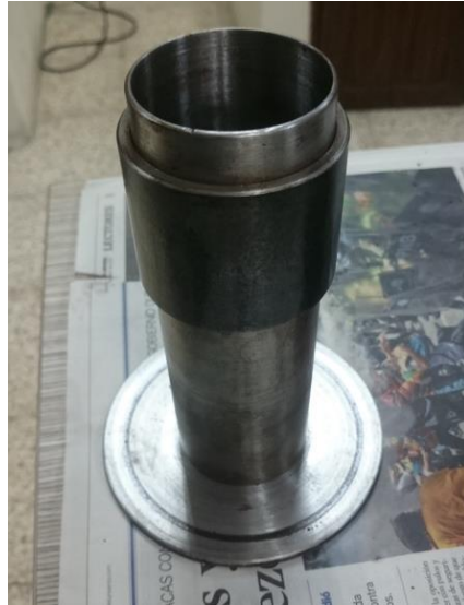
Foto 10: Molde para muestra cilíndrica de \Phi 5 cm
