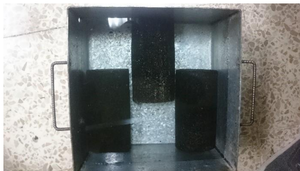
Figura 28. Proceso de inmersión en agua de las briquetas
