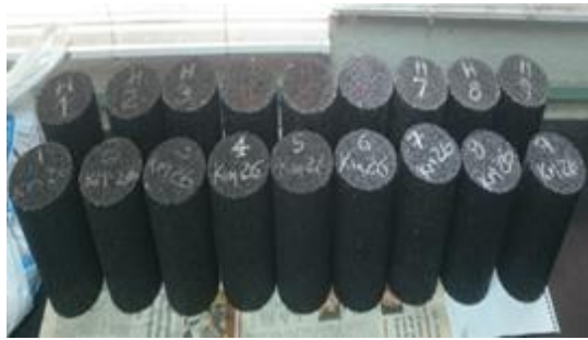
Figura 20. Briquetas de 7.5cm de diámetro por 15cm de altura
