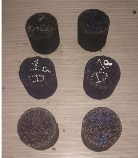
Foto 13: Muestra cilíndrica para ensayo de corte directo
