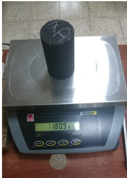
Foto 14: Balanza para la determinación de los pesos
