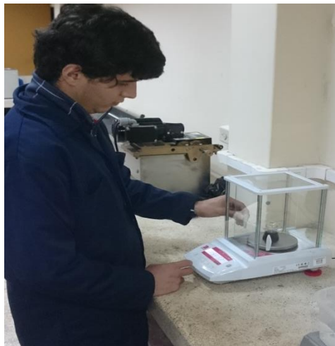
Foto 5: Determinación de gravedad específica del cemento asfáltico
