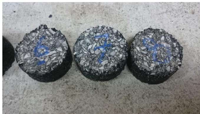
Foto 11: Muestra cilíndrica de 5 cm
