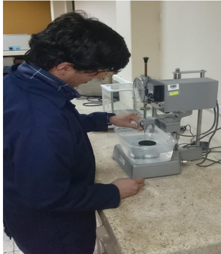
Foto 4: Ensayo de penetración
