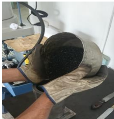
Figura 17. Colocación de la mezcla en el molde
