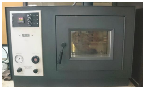
Foto 6: Envejecimiento en el horno rotatorio de película delgada (RTFOT)
