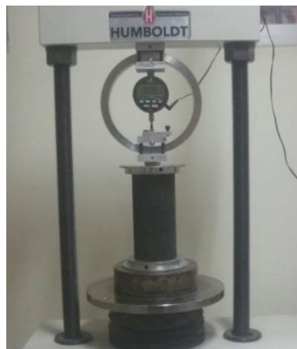
Foto 3: Ensayo triaxial con 0 kPa de carga lateral
