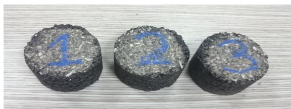
Figura 11. Briquetas de \Phi igual a 5 cm.
