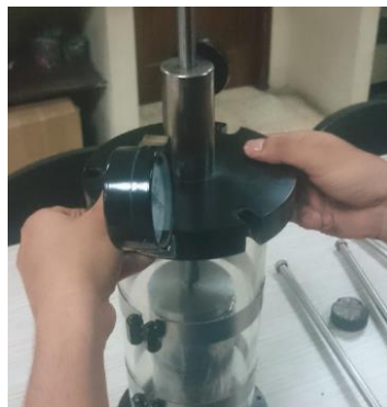
Figura 22. Colocación de la briqueta en la cámara de triaxial
