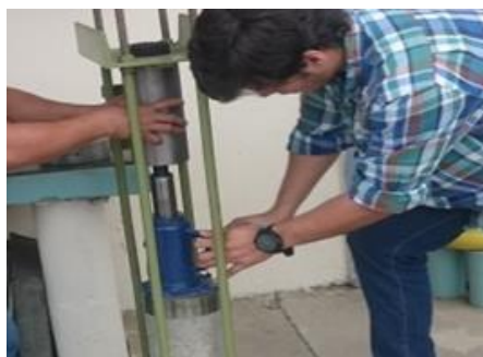
Figura 19. Proceso de desmoldar la briqueta
