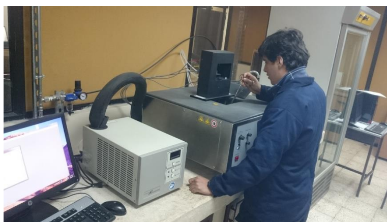
Foto 2: Ensayo en equipo BBR
