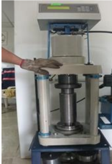
Figura 18. Compactación de la briqueta por la prensa hidráulica
