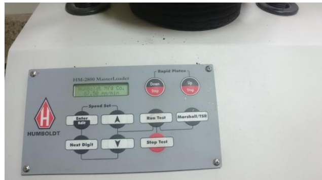
Foto 1: Velocidad de deformación de la prensa hidráulica
