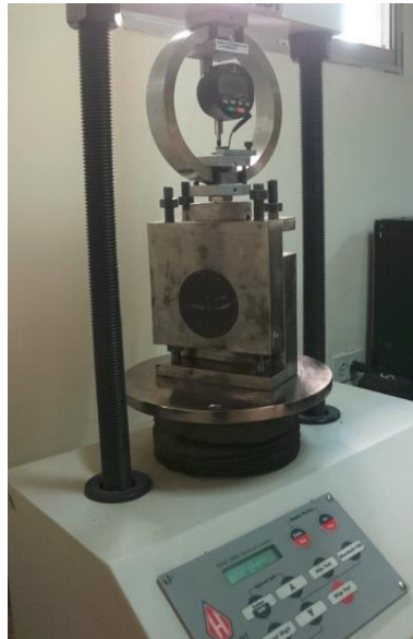
Figura 9. Prueba simple de corte directo
