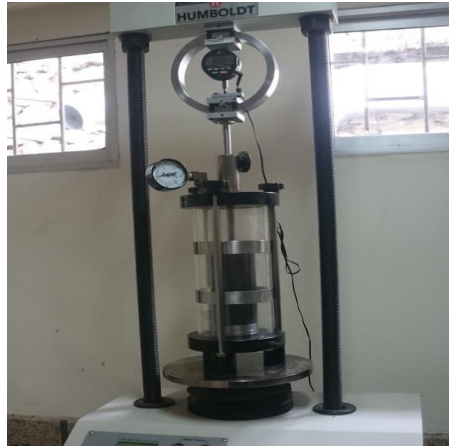
Foto 7: Equipo del ensayo triaxial con presión lateral
