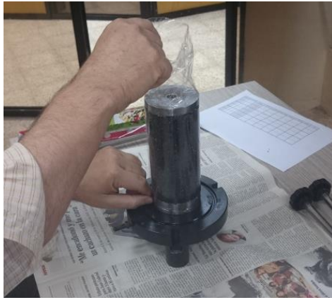
Foto 4: Membrana utilizada para confinar las muestras cilíndricas
