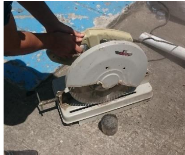
Figura 25. Proceso de cortado de las briquetas
