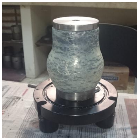
Foto 8: Muestra cilíndrica deformada
