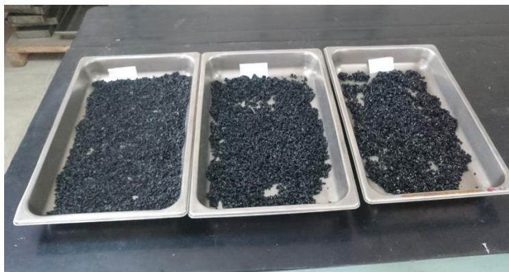
Foto 6: Mezcla asfáltica abierta
