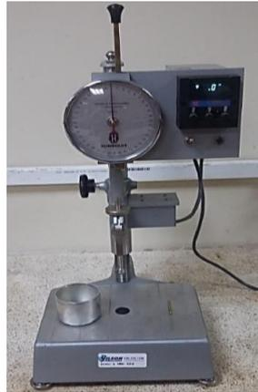
**FIGURA 2. 19 Penetrómetro**
