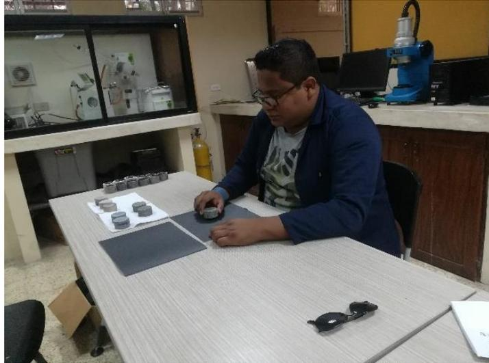
**FIGURA 3. 3 Lijado de pastillas de roca**
