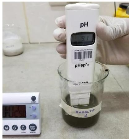
**FIGURA 2. 32 Medidor de pH digital**
