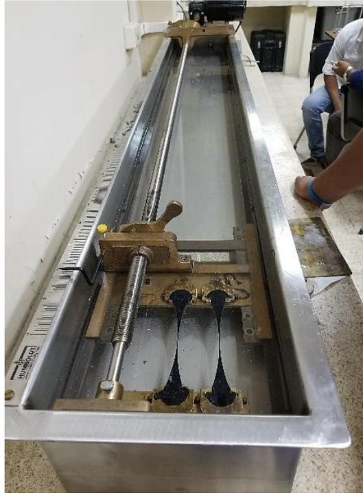
**Ensayo de ductilidad**
