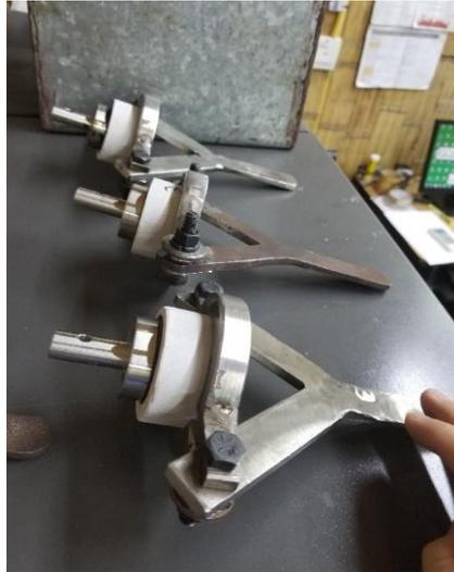
**Sistema de agarre para el ensayo PAP**
