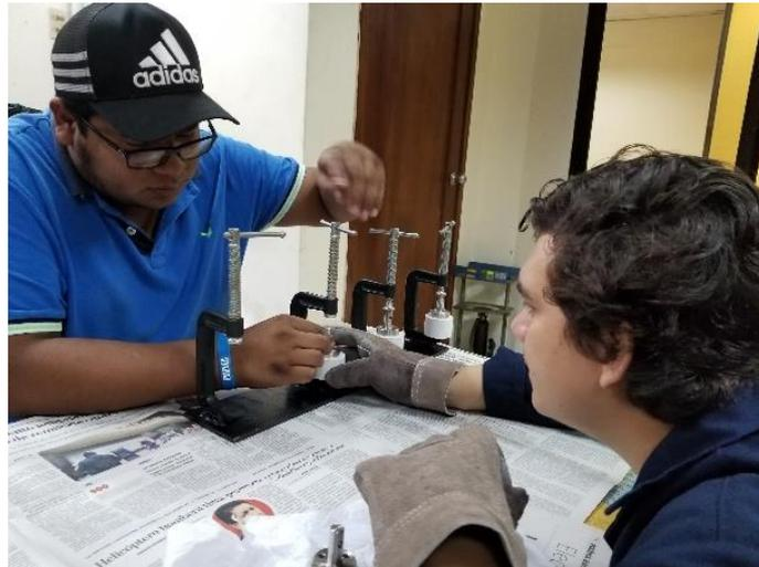
**FIGURA 3. 7 Unión del sistema pastilla de roca - pistón**
