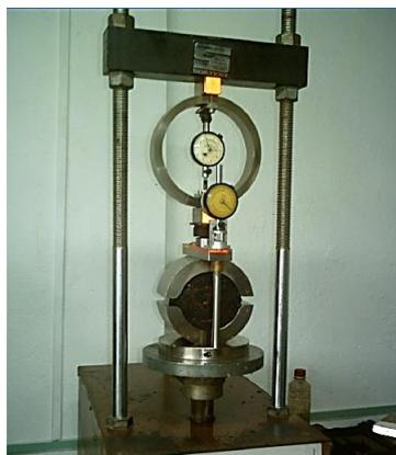
**FIGURA 2. 16 Ensayo de tracción indirecta**
