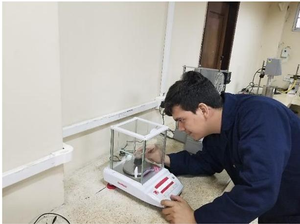
**Determinación de gravedad específica del cemento asfáltica**
