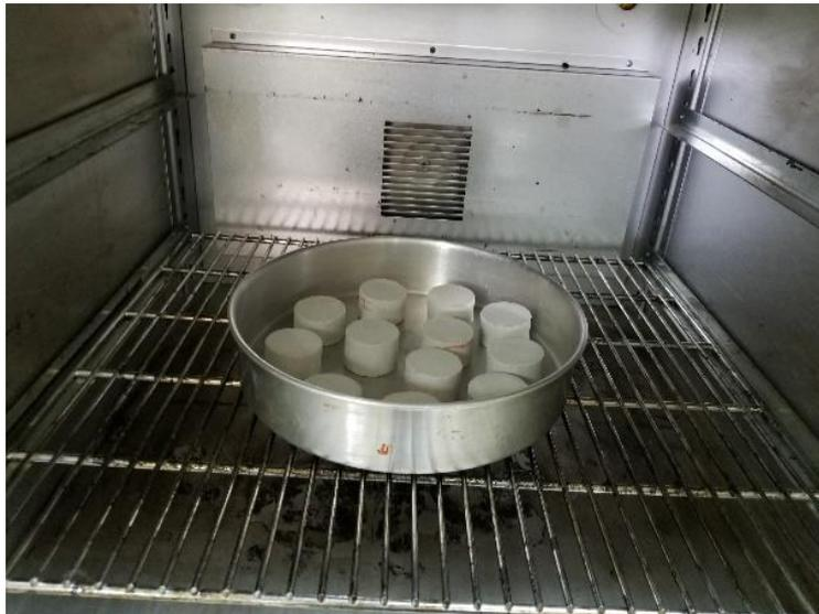
**FIGURA 3. 6 Secado de pastillas de roca en el horno**
