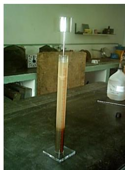
**FIGURA 2. 14 Ensayo equivalente de arena**
