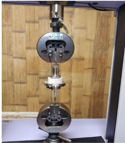
**Ensayo de tracción en prensa universal**
