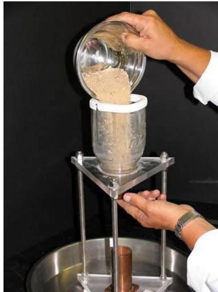
**FIGURA 2. 10 Ensayo de angularidad**
