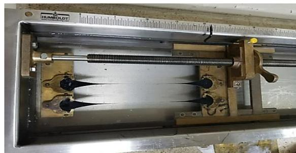
**FIGURA 2. 20 Ensayo de ductilidad**
