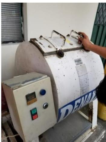
**FIGURA 2. 7 Máquina de prueba de Los Ángeles**
