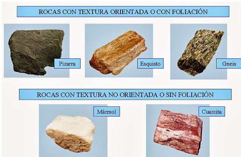
**FIGURA 2. 5 Rocas con textura orientadas con foliación o sin foliación**
