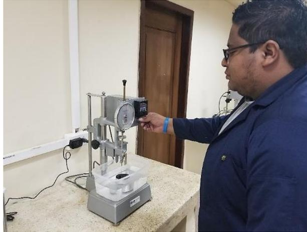
**Ensayo de penetración**
