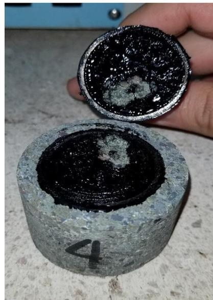
**Tipo de falla por rotura de agregado**
