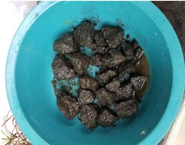
**Ensayo de desgaste ante los sulfatos**
