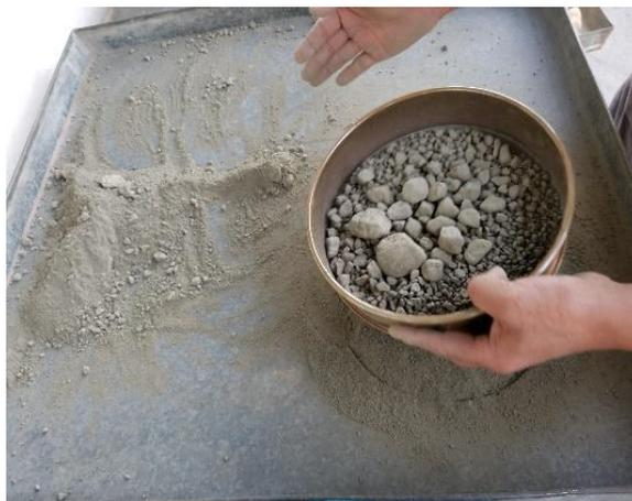
**Tamizado de agregados minerales**
