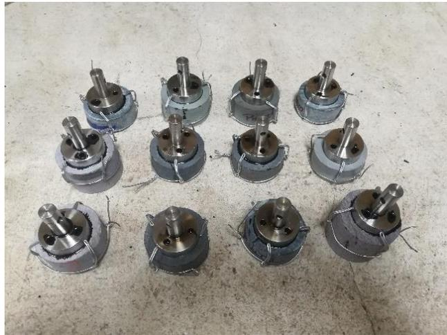
**FIGURA 3. 11 Asegurado de sistema pistón – pastilla de roca**
