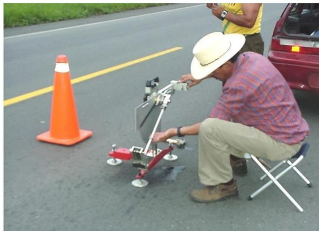
**FIGURA 2. 12 Medición con péndulo de fricción**
