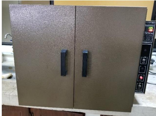
**FIGURA 3. 9 Sistema con asfalto al horno a 135°C**
