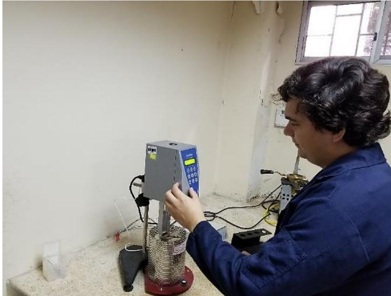
Ensayo en viscosímetro Brookfield
