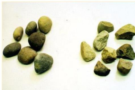
**FIGURA 2. 9 Agregados con caras angulosas y fracturadas**
