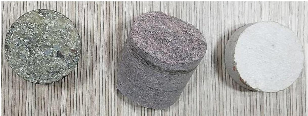
**FIGURA 2. 28 Porosidad de la superficie de los agregados**
