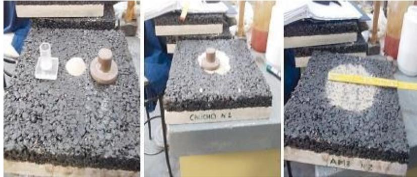
**FIGURA 2. 13 Método del círculo de arena**
