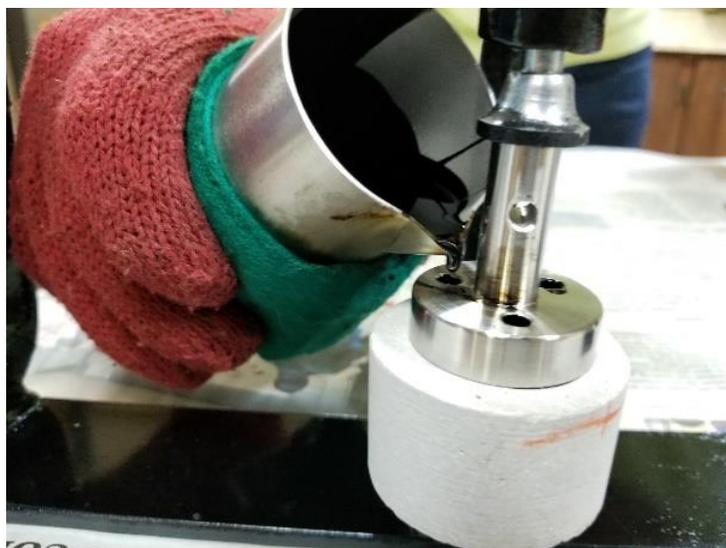
**FIGURA 3. 8 Colocado de asfalto en el sistema**
