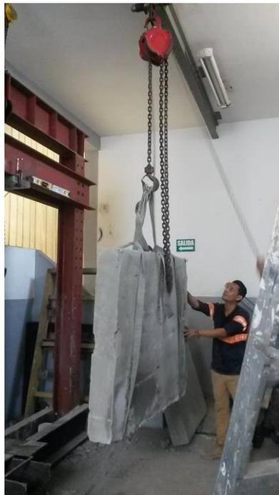
**Ilustración 29.** Ubicación del panel frente al pórtico. Elaboración propia.
