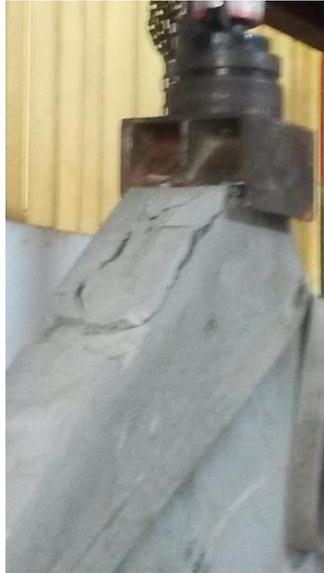
**Ilustración 58.** Falla en la esquina CS. Elaboración propia.
