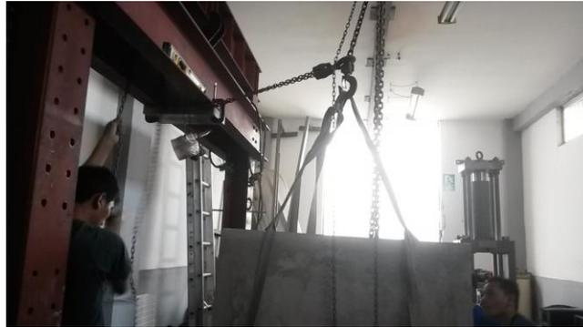
**Ilustración 30.** Uso de un 2do tecele para la ubicación del panel en el pórtico. Elaboración propia.
