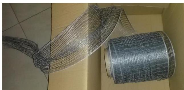
**Ilustración 5.** Malla fibra de acero. Elaboración propia.
