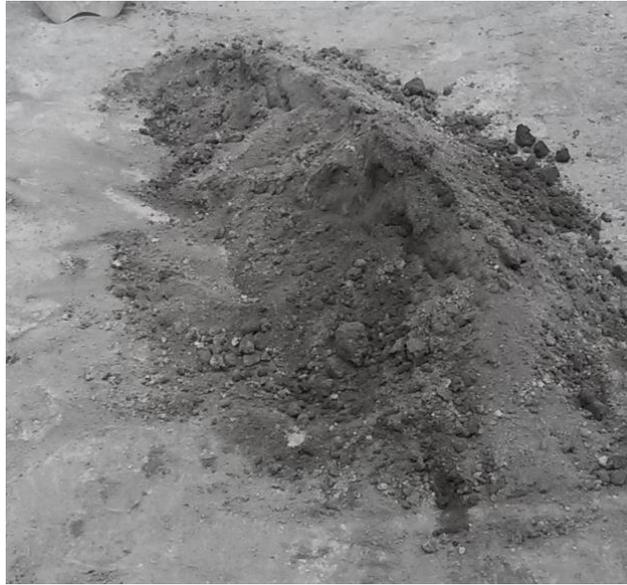
**Ilustración 11.** Mezcla seca del mortero. Elaboración propia.
