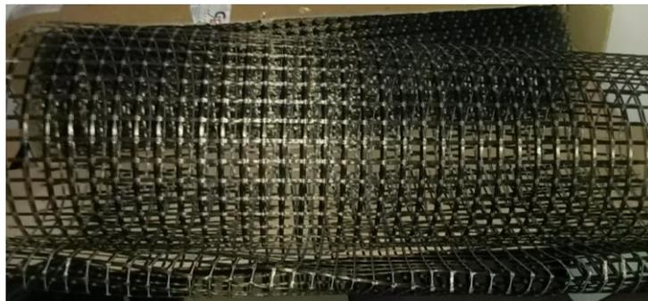
**Ilustración 3.** Malla fibra de basalto. Elaboración propia.
