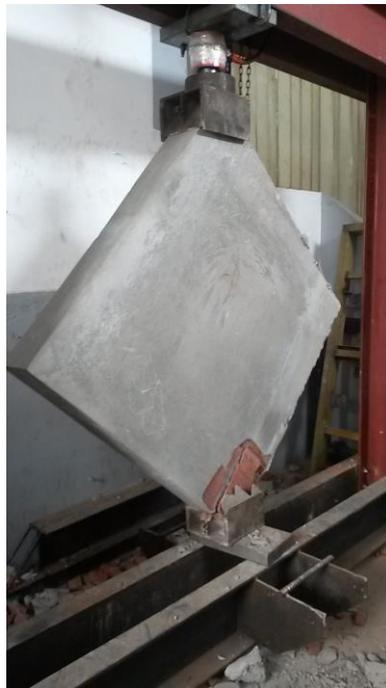
**Ilustración 55.** Falla en la esquina AV. Elaboración propia.
