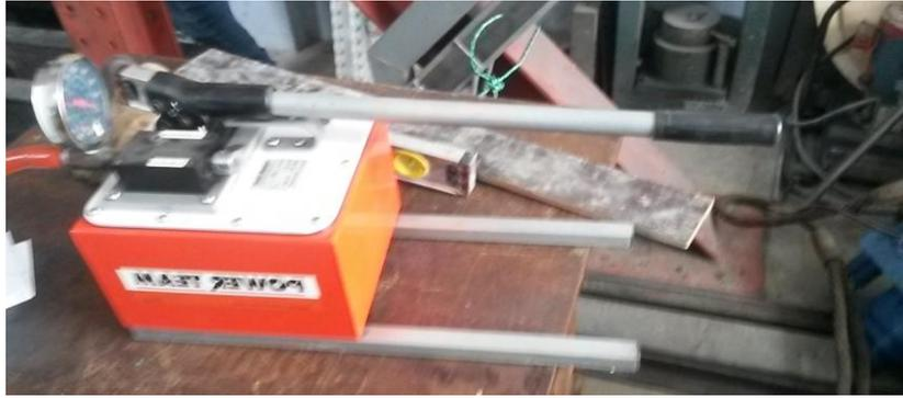
**Ilustración 28.** Instrumento donde bombea presión mediante a una manguera para que el gato aplique carga. Elaboración propia.
