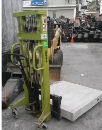
**Ilustración 21.** Apilador manual hidráulico. Elaboración propia.
