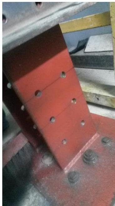
**Ilustración 19.** 6 perforaciones de una cara de la viga. Elaboración propia.
