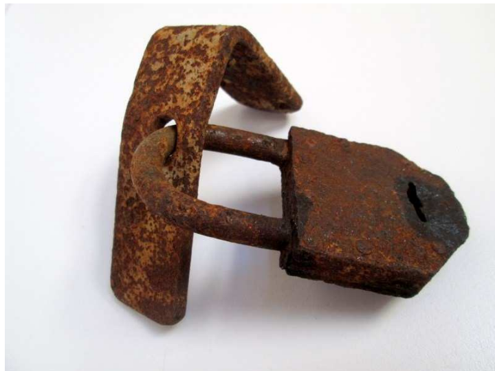
Ilustración 2.2:10: Metales oxidados por exposición, oxidación electrolítica. Fuentes: el autor
