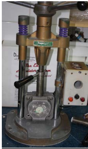
Fig. No 58. Inyectando el material.
