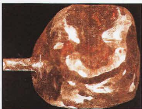
Fig. No. 56: Coping con capa de oxidación irregular provoca deficiencia de la unión entre la cerámica y el metal
