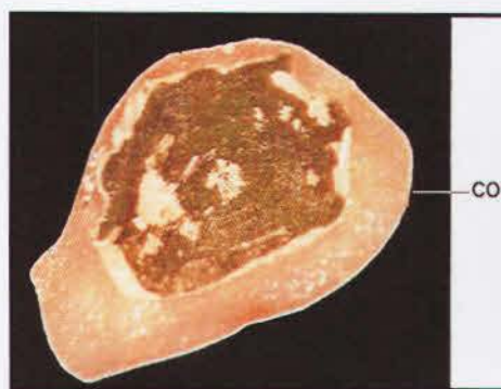
Fig. No. 57: Capa de oxido (CO) que se desprendió de la estructura metálica y arrastro un fragmento de cerámica de recubrimiento.
