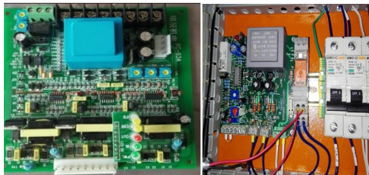
Figura 2.2 Reguladores de Potencia Fuente: Autor
