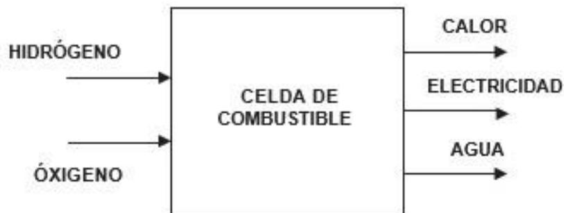
Imagen 9. El Diagrama Básico de una Celda de Combustible. ("CD-6497.pdf", s/f)
