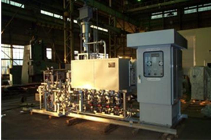
Imagen 6. Ejemplo Básico de un Electrolizador Monopolar. (Hitachi Zosen Corporation, s/f)
