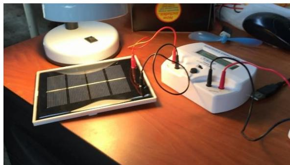
El Monitor FCJJ-24 Recibe Energía del Panel Solar
