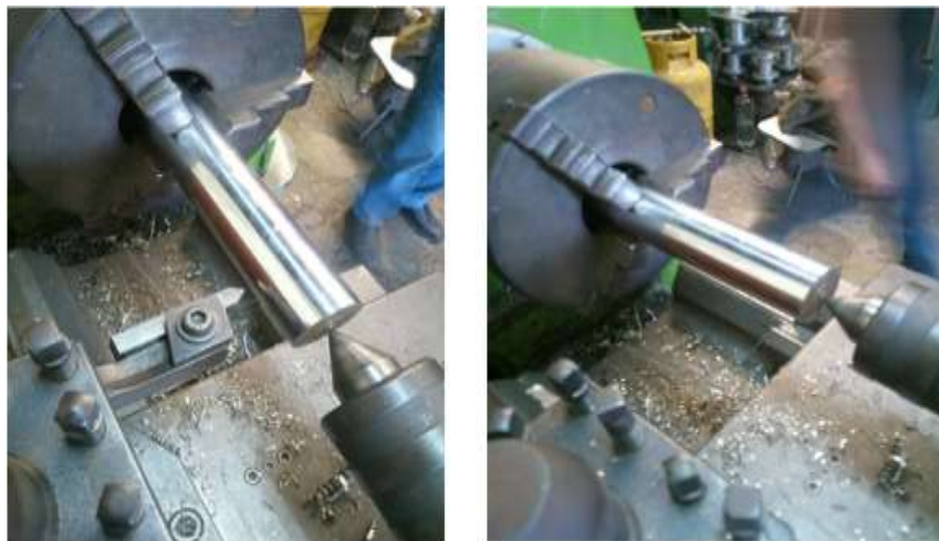
Figura 4. 1. Construcción del eje de 1 pulgada
