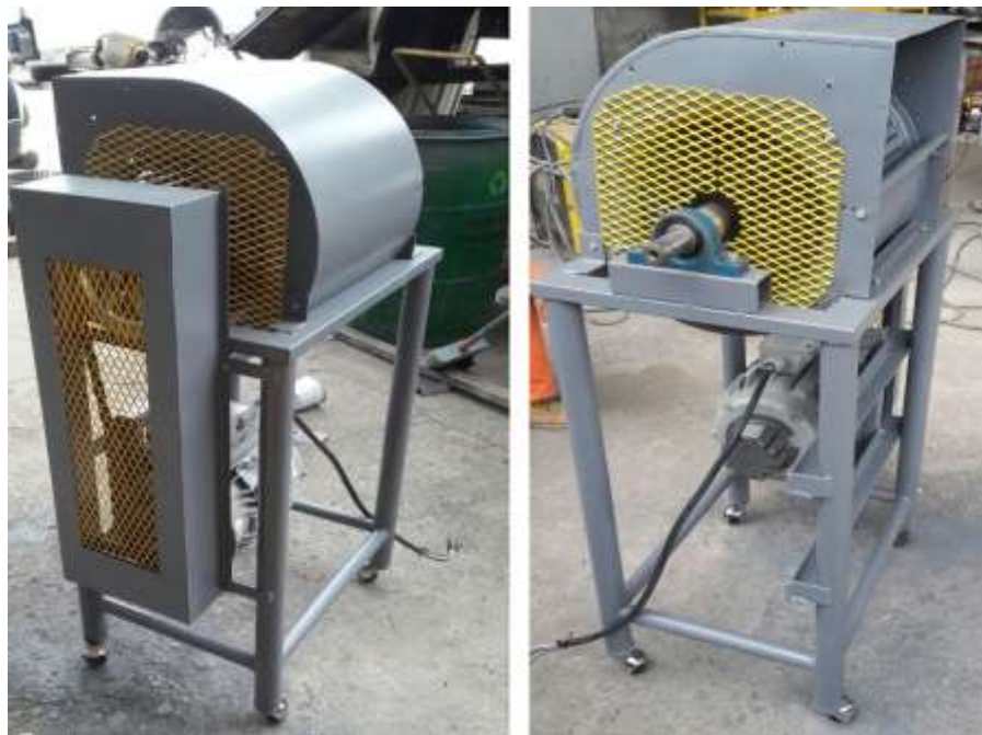
Figura 4. 9. Acabado final con pintura anticorrosiva
