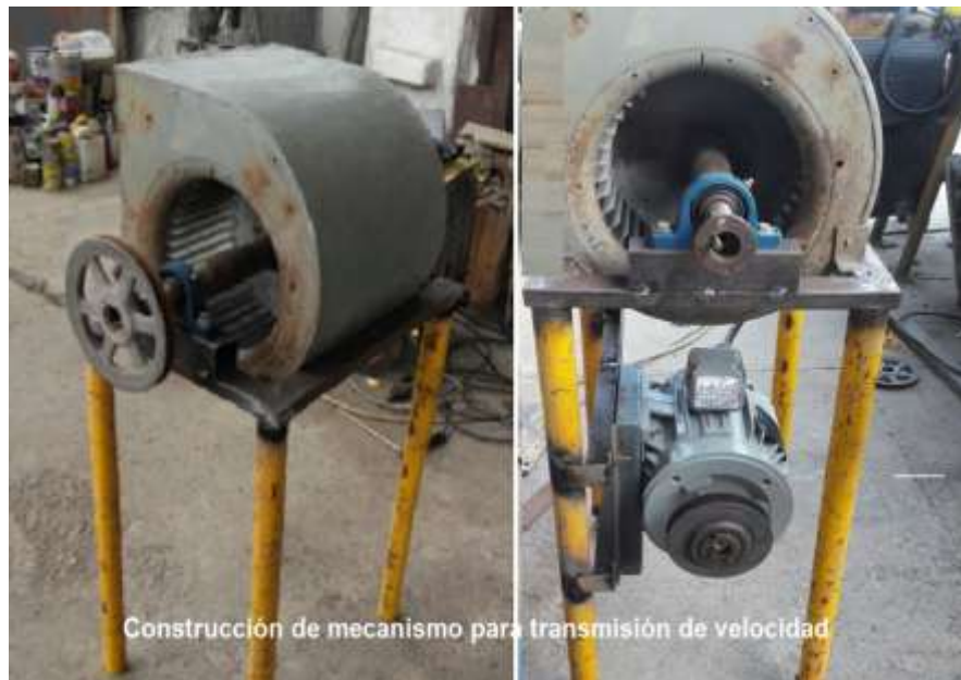
Figura 4. 4. Construcción de mecanismo para transmisión de velocidad.
