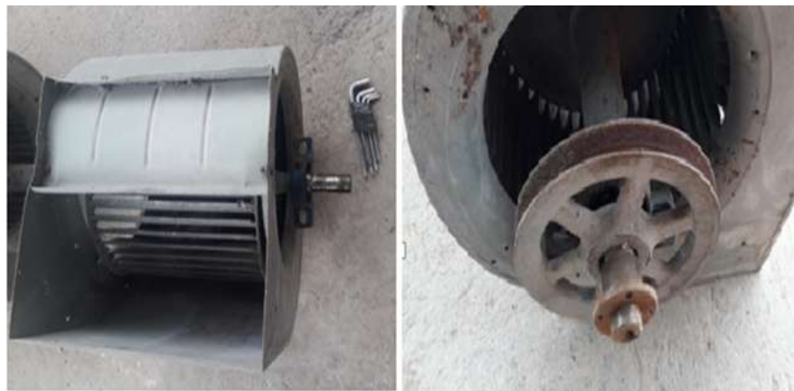
Figura 4. 3 Limpieza y construcción de los componentes (polea y turbina)
