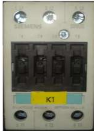
Figura 3. 12. Contactor Trifásico Siemens 35Amp.
