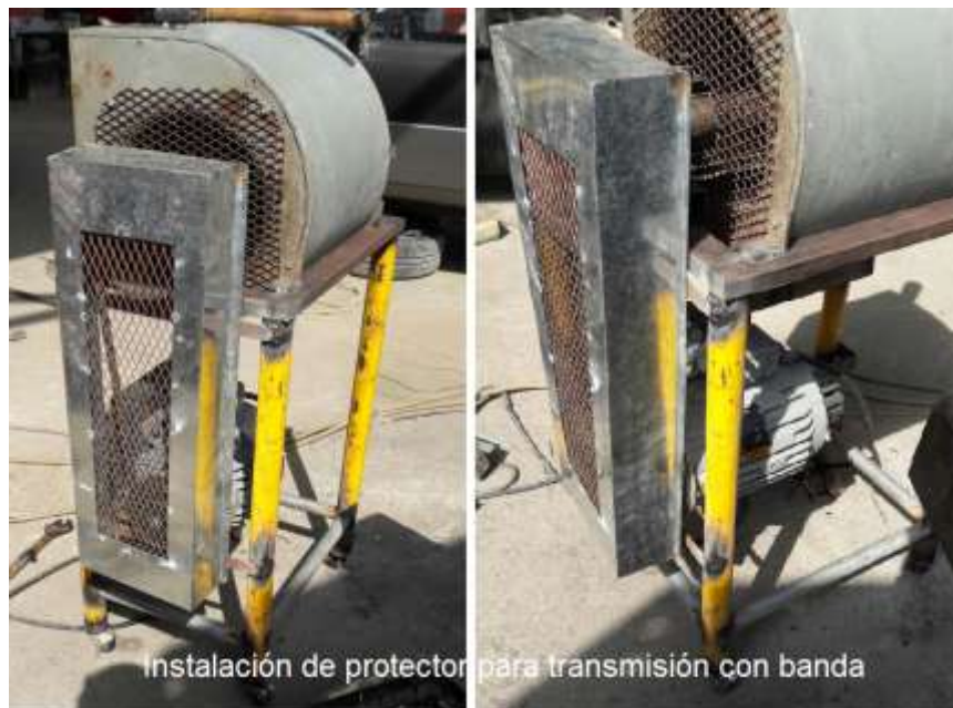
Figura 4. 6. Instalación de protector para transmisión con banda
