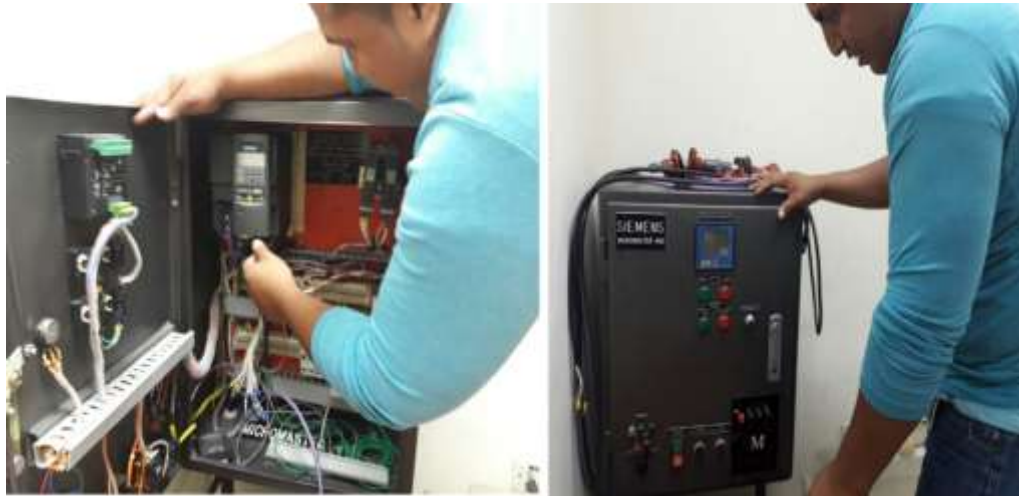
Figura 4. 10. Conexión a módulo Micromaster 440
