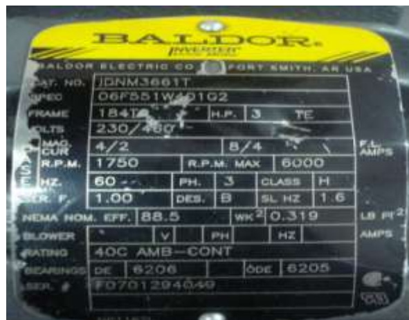
Figura 2. 6Placa de características de un motor eléctrico
