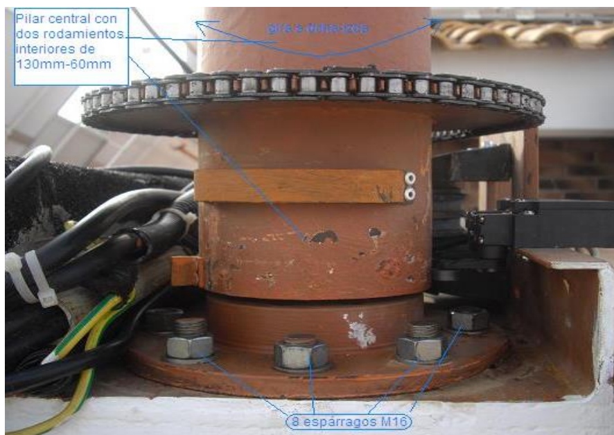
ANEXO B. 3 Sistema de anclaje
