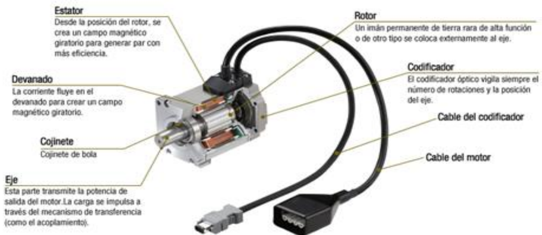
FIGURA 2. 30 Partes básicas de un servomotor.
