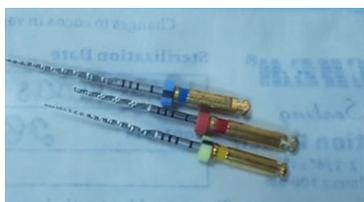
**Figura 1:** Limas fracturadas por torsión durante prueba piloto. **Fuente:** Autor
