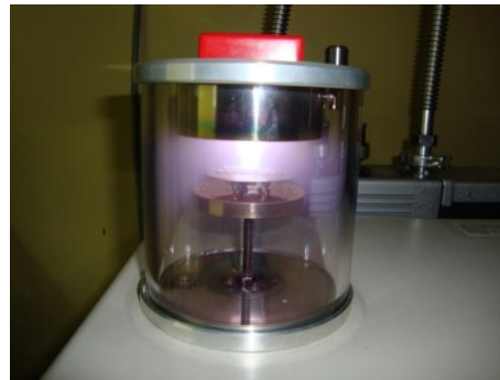
Fig. N° 38: Destello a chorro Fuente: Alejandro Merino Inst. Nacional de Higiene y Medicina Tropical
