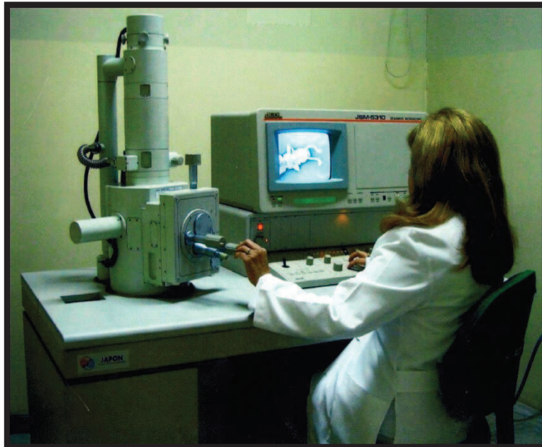
Fig. No. 36: Operación del SEM
