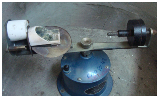
Fig. No. 8.6 El crisol en la centrifuga girando rápidamente. Fuente: John J. Párraga Mera.
