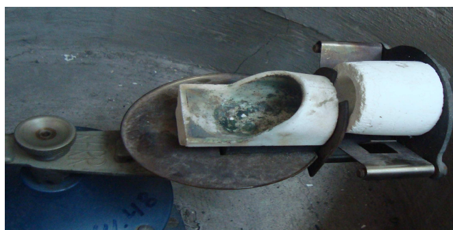
Fig. No. 8.7 El crisol después de la centrifugación. Fuente: John J. Párraga Mera.
