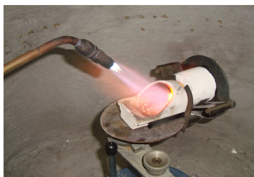
Fig. No. 8.5 Fundido del metal en el crisol Fuente: John J. Párraga Mera.
