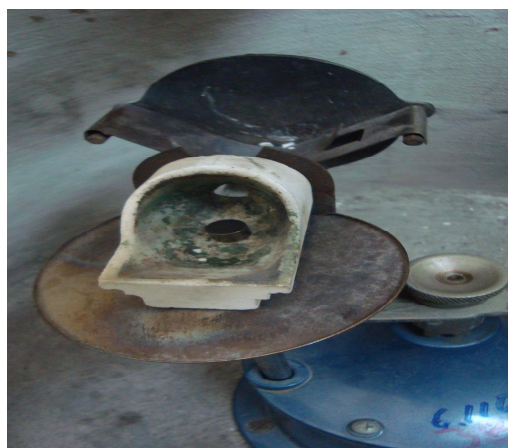
Fig. No. 8.4 El crisol en la centrifuga con el metal. Fuente: John J. Párraga Mera.
