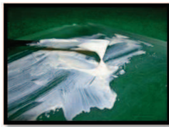
Fig.6. mezcla cemento de obturación
