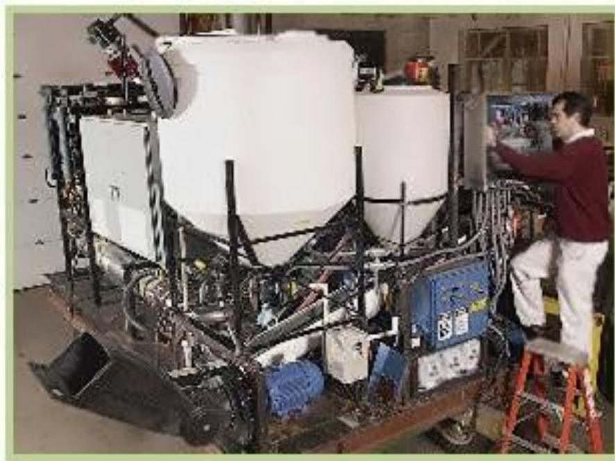
Gráfico 20. Primera Evidencia: Generador Portátil que transforma la basura en electricidad
