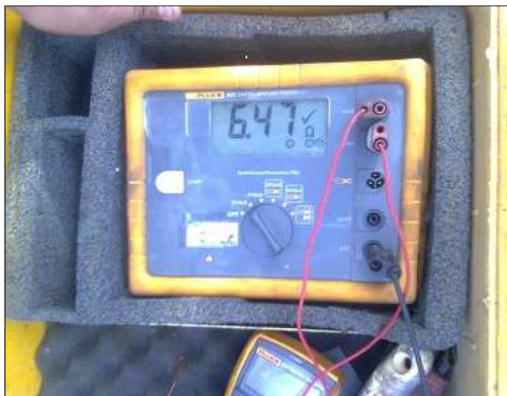
Figura 5.13 LECTURA DEL INSTRUMENTO: 6,47 ohmios
