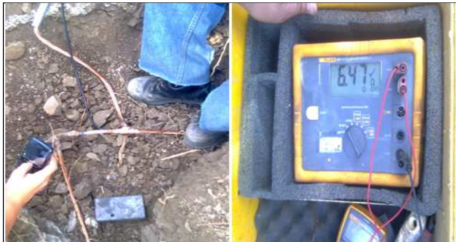
Figura 5.12 Resistencia del sistema de tierra
