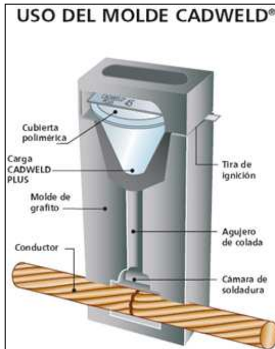
Figura 2 Uso del Molde de Grafito para la Soldadura Exotérmica
