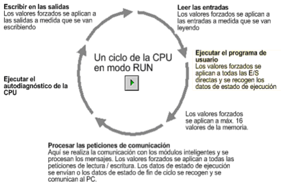
Figura 5.11: Ciclo de la CPU en modo RUN
