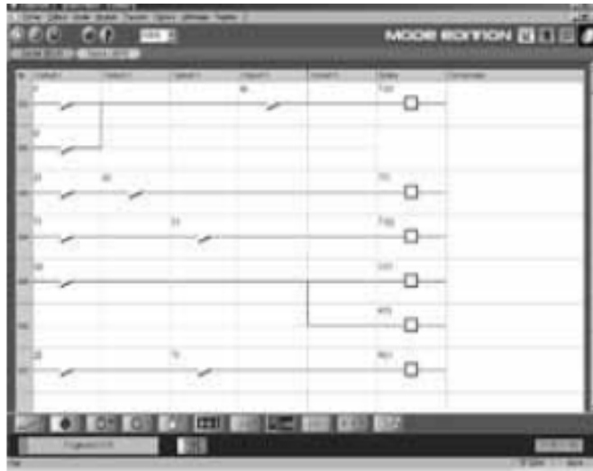
Figura 3.6: Ventana de presentación del lenguaje de programación LADDER.
