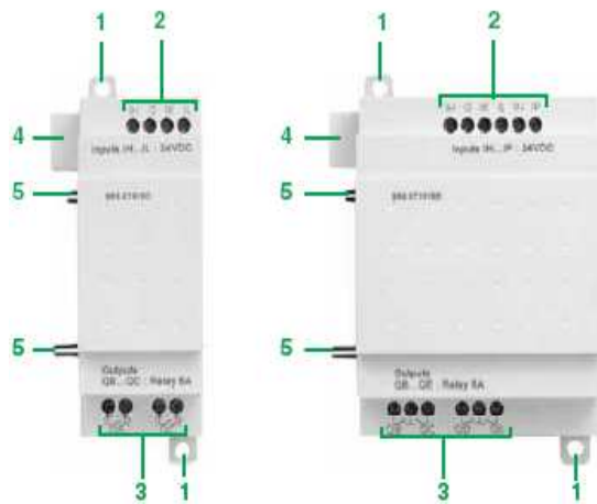
Figura 3.5: Extensiones de entradas/salidas TON incluyen en el frontal: (1) Dos patas de fijación retráctiles. (2) Bornas de conexión de las entradas. (3) Bornas de conexión de las salidas. (4) Un conector para la conexión al relé programable Zelio Logic. (5) Pestañas de fijación.
