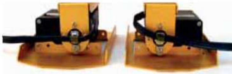
Figura 3.63: Aspecto de los pies con las sujeciones de los cables instaladas.
