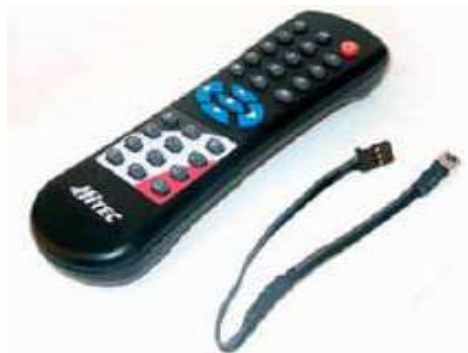
Figura 3.143: Control remoto Remocon y su receptor Infrarrojo.
