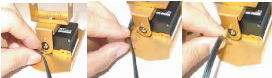
Figura 3.61: Doble la sujeción sobre el cable.
