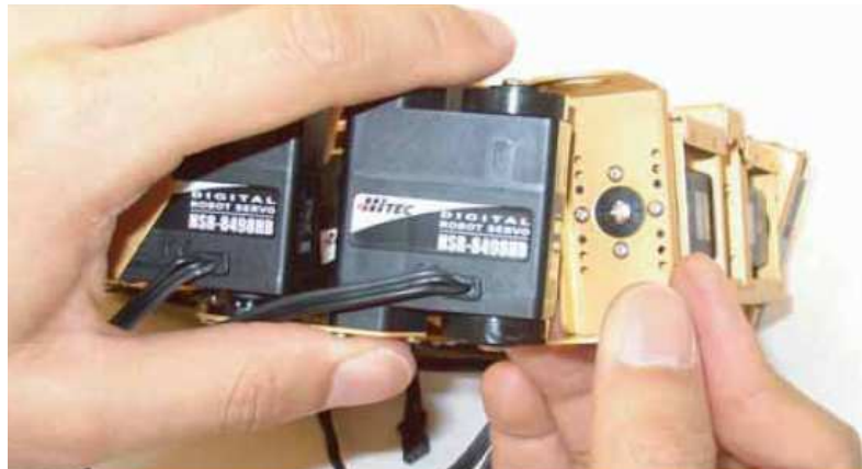
Figura 3.21: Colocar una pletina a un servo
