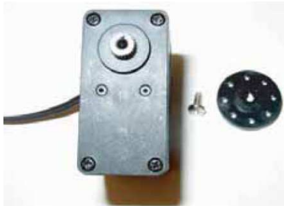
Figura 3.15: Servo con el horn con muesca quitado.
