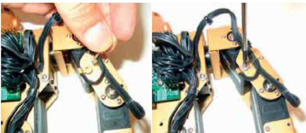
Figura 3.124: Orejuela y cables montados.
