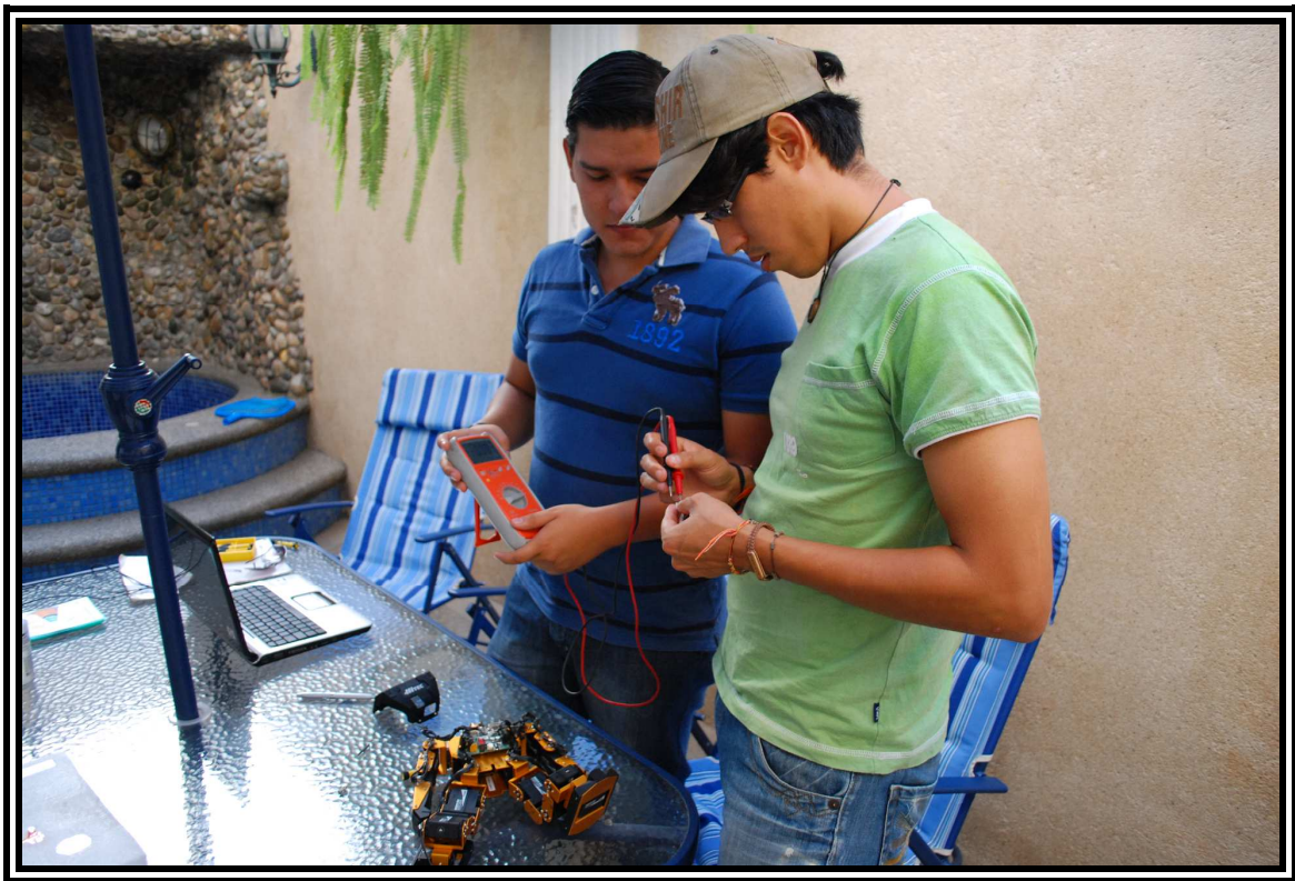
Figura 5.7: Medición de voltaje de la batería.
