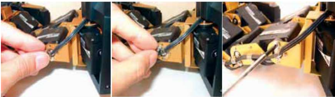
Figura 3.120: Sujeción de los cables
