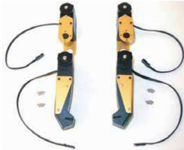
Figura 3.74: Montaje del antebrazo completo.
