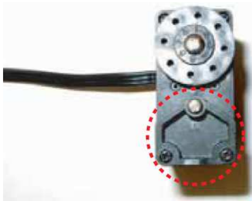
Figura 3.18: Zona de montaje del servo HSR-8498HB1
