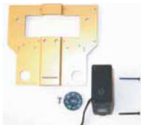
Figura 3.80: Quite los horns frontales de cada servo.
