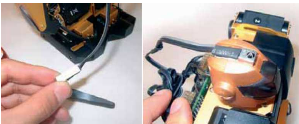
Figura 3.149: Instalación del Remocon y el Receptor IR (Paso F)
