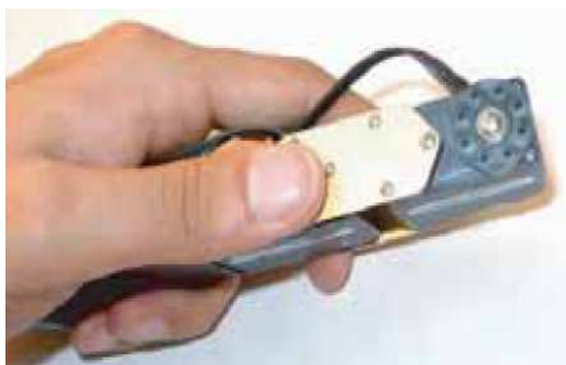
Figura 3.20: Como fijar la platina en el Servo
