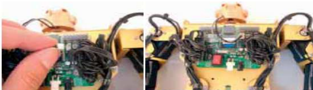
Figura 3.132: Muestra el conector del LED en el controlador
