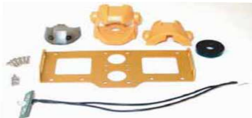
Figura 3.97: Elementos necesarios para la unión de la cabeza y el cuerpo.
