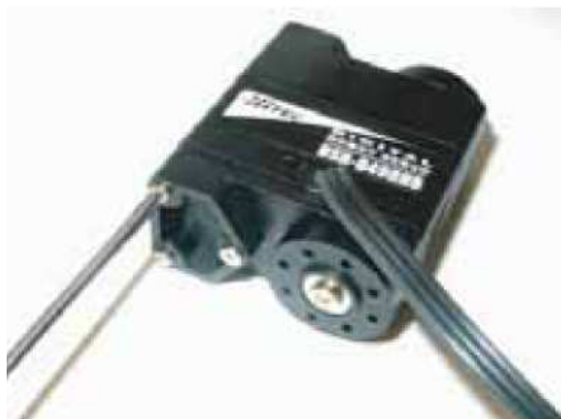
Figura 3.19: Aflojar los tornillos del pentagono
