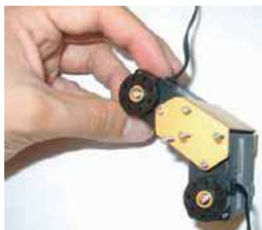
Figura 3.49: Fijar los tornillos de la rodilla
