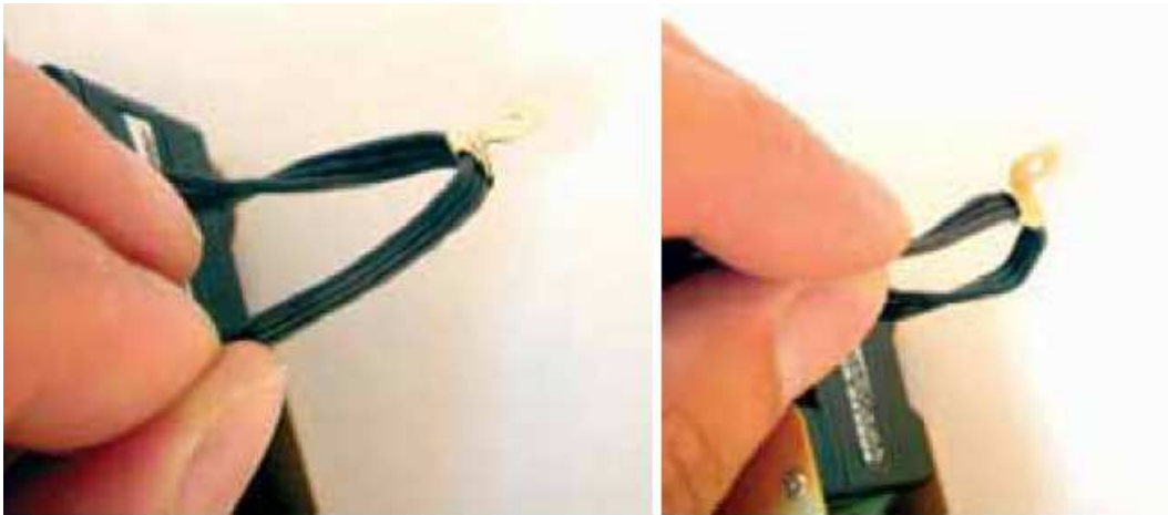
Figura 3.123: Ejemplo de cómo unir la orejuela y la sujeción de cables.
