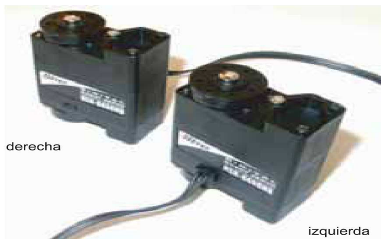
Figura 3.6: Los cables conectores tienen 3 orientaciones distintas
