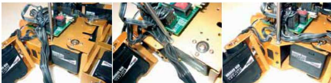
Figura 3.121: Sujeción de los cables parte trasera.
