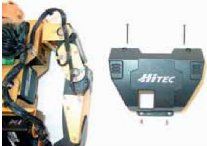
Figura 3.133: Ubicación de los tornillos en la tapa trasera.
