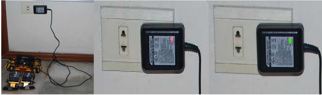
Figura 3.141: Batería en estado conectado y cargando
