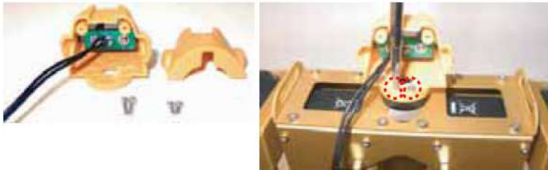
Figura 3.103: Instalación de la cabeza.
