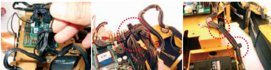
Figura 3.129: Imagen de los cables unidos por presillas.
