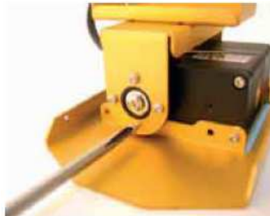
Figura 3.60: Quite el tornillo que está por debajo del horn libre.
