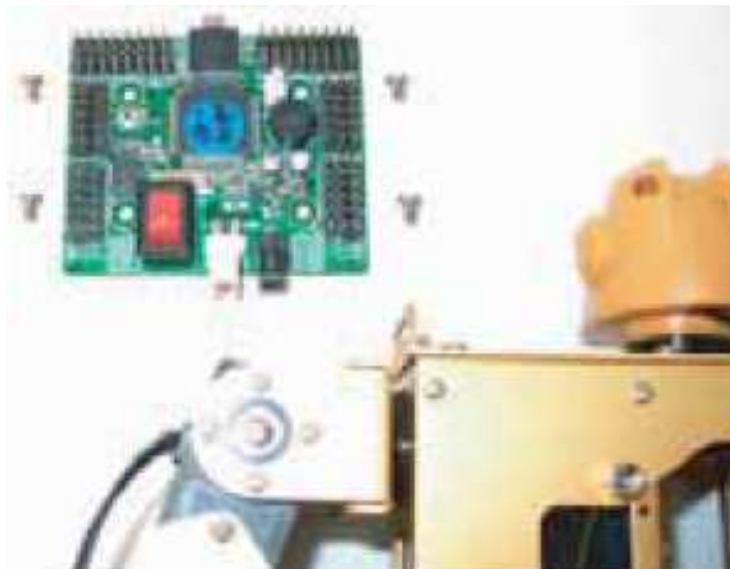
Figura 3.109: Instalación del controlador en el Robot.
