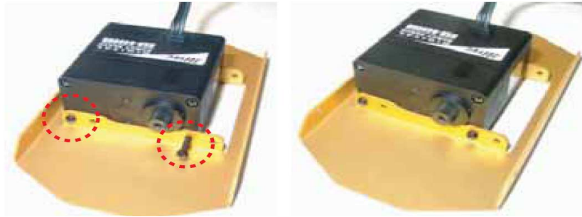
Figura 3.26: Montaje del pie derecho
