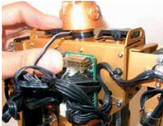
Figura 3.147: Instalación del Remocon y el Receptor IR (Paso D)
