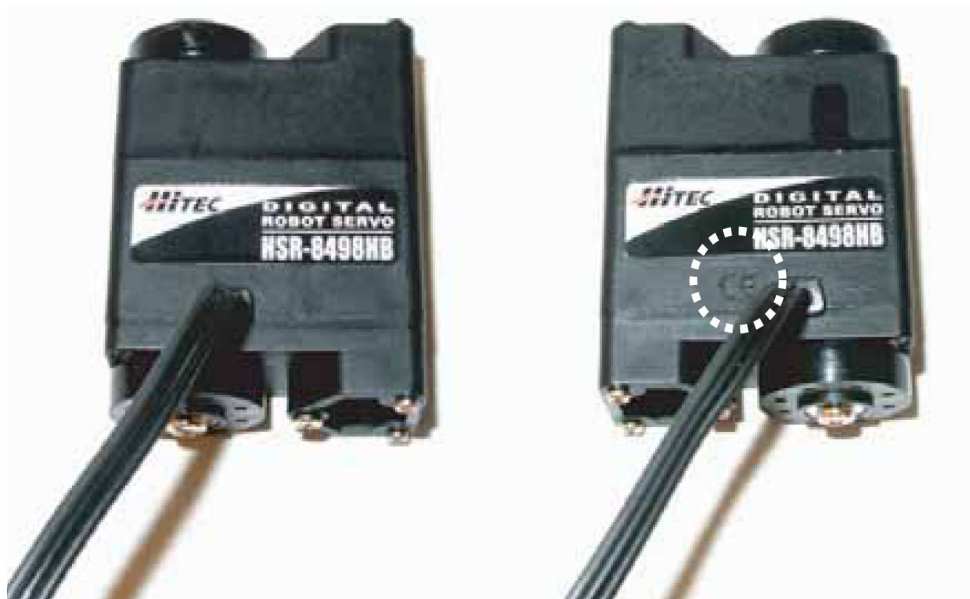
Figura 3.7: Identificación del lado del servomotor con el símbolo CE
