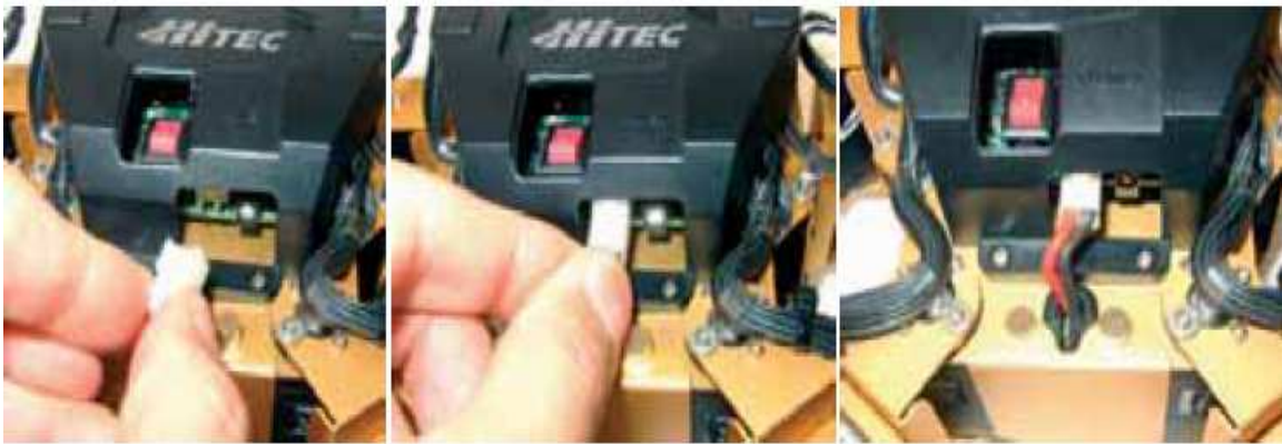
Figura 3.139: Conexión de la batería a la tarjeta del microcontrolador
