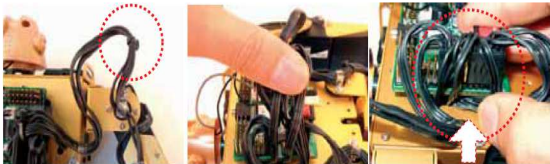
Figura 3.128: Fijación de los cables con los sujetadores
