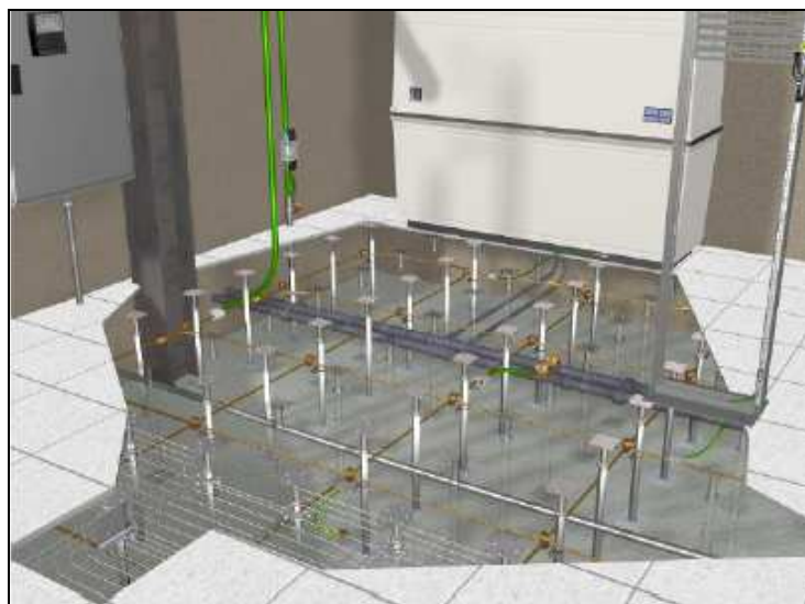
Figura 1.14 Conexión equipotencial bajo suelo falso
