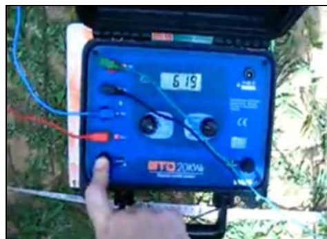
Figura 2.2 Medición con método Wenner en suelo Limoncito igual a 6.19\Omega Fuente: Mediciones con telurómetro alquilado proyecto Ríos-Sánchez
