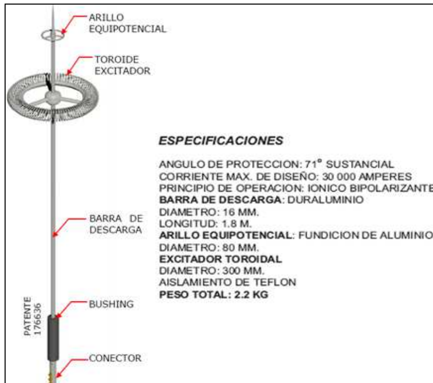
Figura 4.5 Pararrayo Reactivo-Ion; PARRES Tipo Dipolo para Torre de Telecomunicaciones de Limoncito
