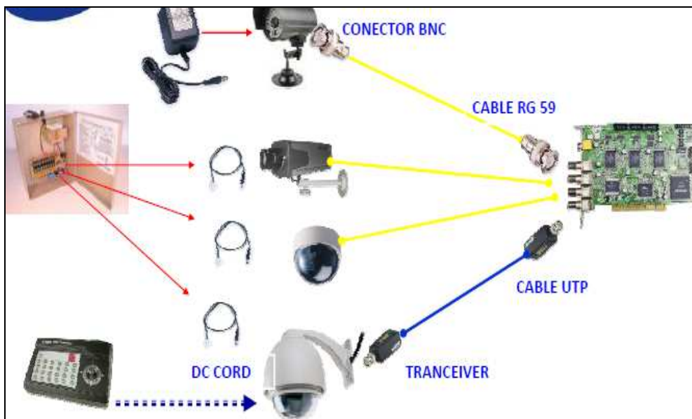
Figura 3.36 Sistema de video vigilancia sus conexiones
