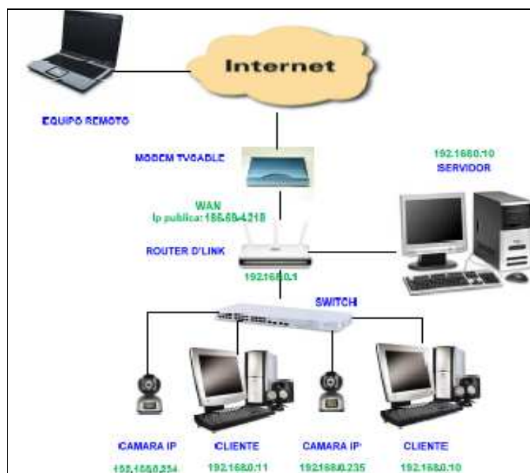
Figura 3.5 Esquema de video vigilancia remota con cámara IP
