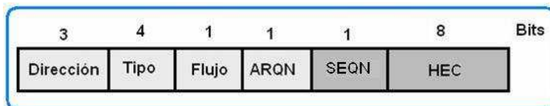
Figura 2.10 Diagrama de cabecera del paquete Bluetooth
