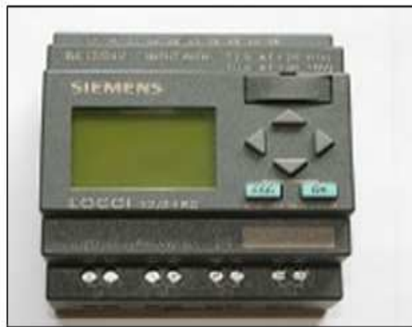
Fig.2-3 Un Controlador Lógico Programable (PLC)
