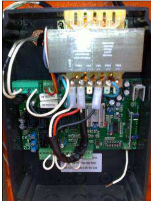
Fig. 4-8 Tarjeta electrónica de control al servo-mecanismo
