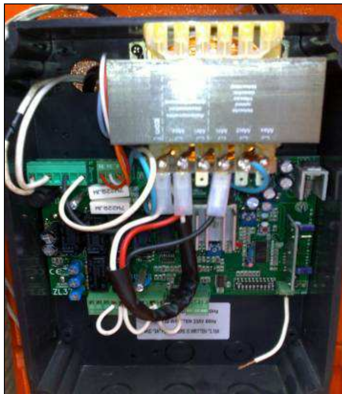
Figura 5-7 Tarjeta electrónica de la torre de la barrera vehicular
