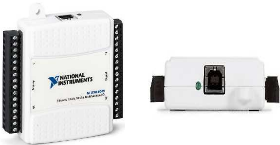
Figura 3. 1: Vista lateral y conector del USB-600
