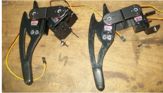
Figura 4. 10 Patas del robot hexápodo tipo radial. Fuente: Autores
