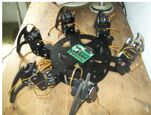
Figura 4. 12 Vista superior del chasis del robot hexápodo tipo Fuente: Autores
