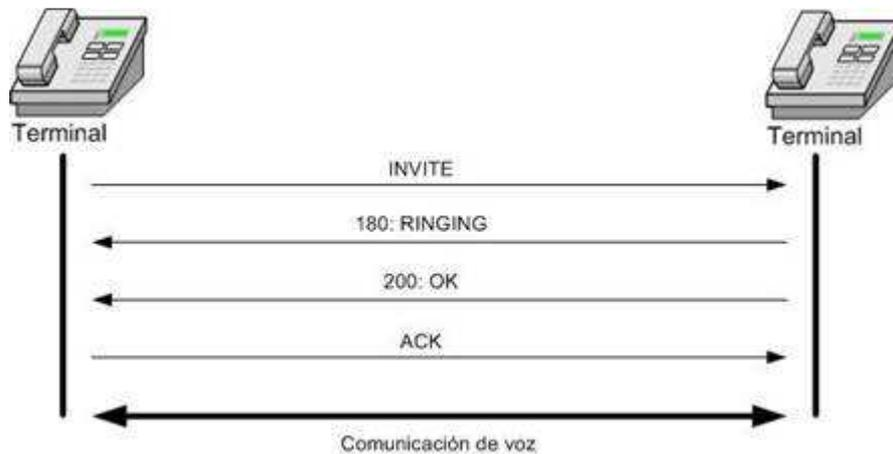
Figura 2.1 Funcionamiento de Protocolo SIP.
