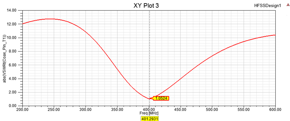
Figura 2.8. Razón de onda estacionaria de la antena implantable. Elaborada por el Autor
