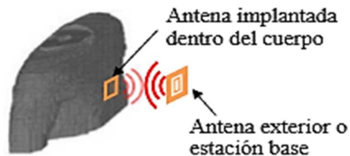
Figura 1.6. Esquema básico de comunicación entre antena implantable y antena exterior.
