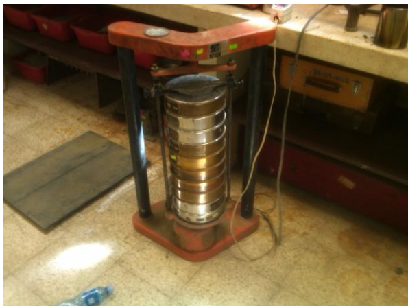
Figura 6 Tamizado de los agregados pétreos
