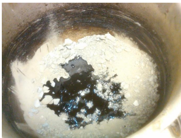
Figura 9 Colocación del asfalto
