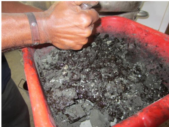
Figura 18 Mezclado de asfalto junto con los agregados
