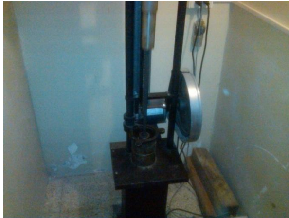
Figura 12 Compactación de las mezclas
