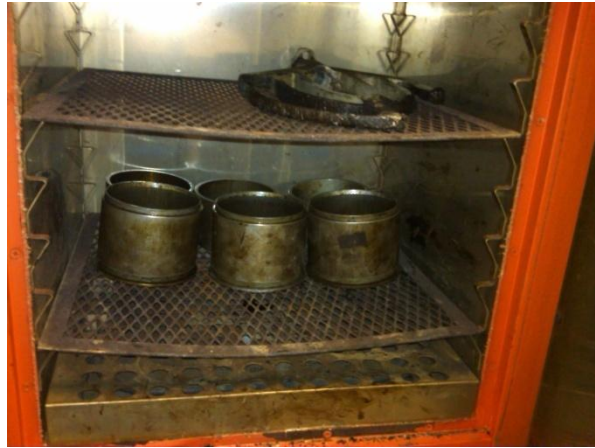
Figura 10 Calentamiento de los moldes
