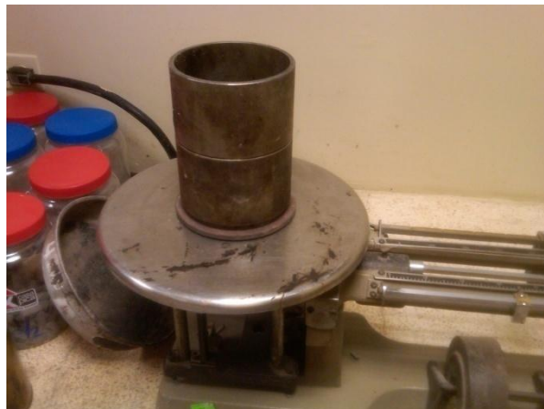
Figura 11 Colocación de los 1200 g de material
