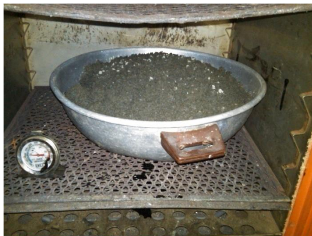
Figura 5 Secado de los agregados pétreos a 110 grados centígrados
