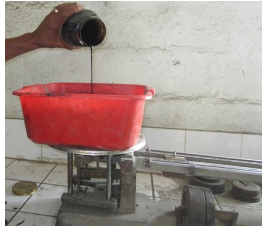
Figura 17 Colocación de 627 gr de Emulsión
