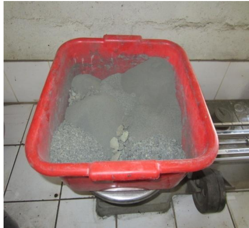
Figura 15 Colocación de los 5000 gr de material
