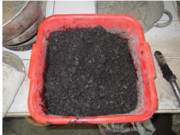
Figura 18 Mezclado de asfalto junto con los agregados
