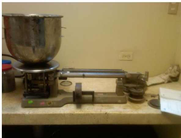
Figura 8 Pesado de los Agregados (5000 g)
